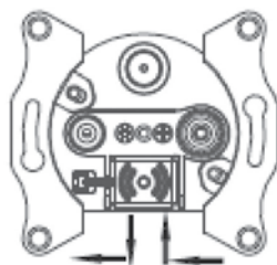
Розетка TV/R/SAT, проходная
